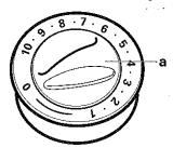
2. Tourner le bouton de réglage (a) en position de thermostat 1-10 et l'enfoncer en butée. Dans cette position, l'allumage s'effectue automatiquement (bruit d'étincelle) jusqu'à ce que la flamme brûle
