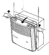
Tirer l'habillage vers l'avant par le haut, presser latéralement les ressorts de retenue vers le haut et rabattre l'habillage vers l'avant. (En cas de manque de place, tirer l'habillage vers l'avant par le haut, puis soulever jusqu'à ce que l'habillage soit dégagé et le retirer).
