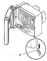
Pour le montage, placer l'habillage sur les colliers de fixation (1) inférieurs. Insérer la barre de commande par le dessous dans la douille de la poignée et laisser l'habillage s'encliqueter en haut.
