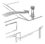
Les constructeurs de camping-cars sont priés de déterminer par des essais sur route, et en accord avec le service après-vente Truma, la combinaison optimale de chapeau de cheminée et - éventuellement - de rallonge pour les différentes versions de leurs véhicules. Selon le modèle de véhicule et la topographie du toit, il peut être nécessaire de monter dans certains cas l'un des chapeaux T1 (nº de réf. 30700-01) ou T2 (n° de réf. 30700-02).
